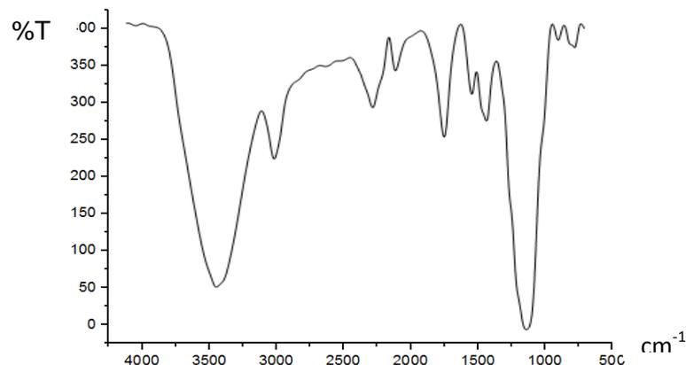
Gambar 4. Spektrum FTIR Komposit Zeolit-Selulosa dari Serat Daun Nanas
